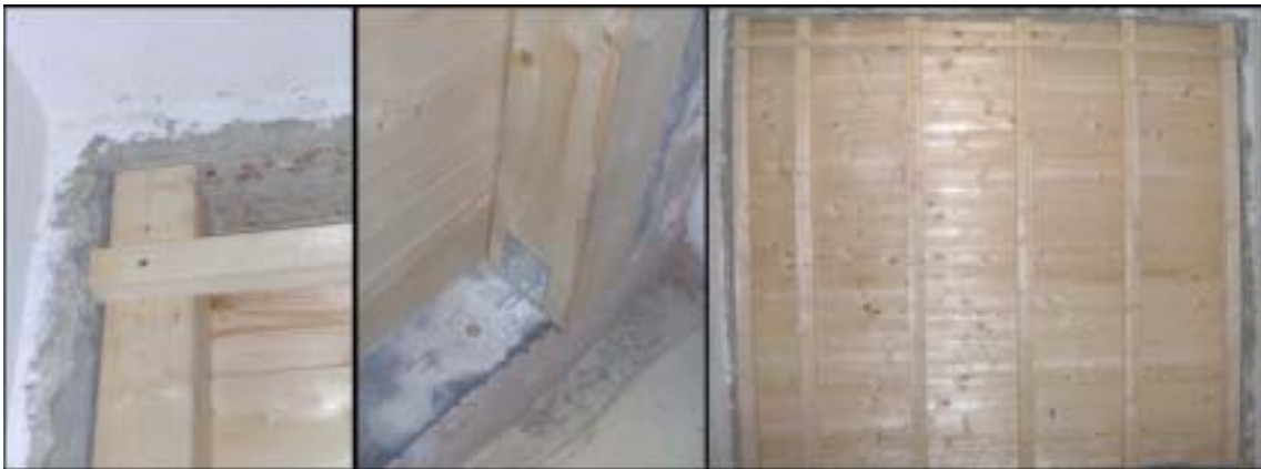
Figura 2 – Campione in prova camera ricevente. Da sinistra a destra: particolare di posa lato superiore, particolare di posa lato inferiore, vista campione nella camera ricevente.
